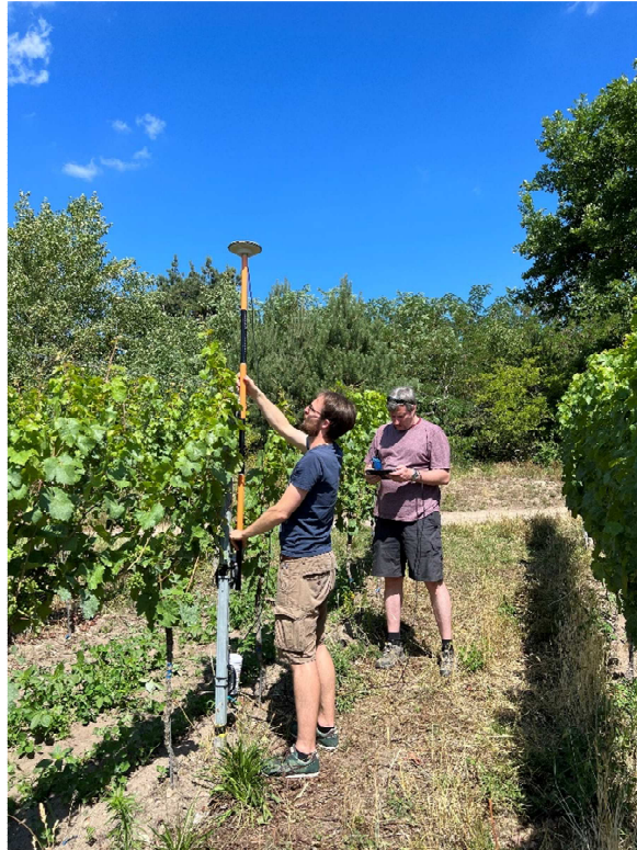
Abbildung 45 Mark Deubert (links) und Kai Thomas (rechts) messen in Bad Dürkheim die präzisen GPS Koordinaten mit einem RTK Modul ein
