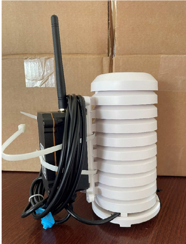
Abbildung 39: Im Büro vorbereiteter Sensor mit Funkmodul (links) und Wetterschutzhülle mit inliegendem Fühler (rechts)
