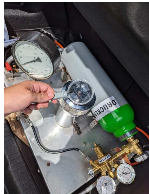
Abbildung 13: Links: Funktionsprinzip einer Scholander-Bombe. Rechts: Scholander-Bombe die im VitiMikroKlim Projekt benutzt wurde. Quelle Bild links: https://de.wikipedia.org/wiki/Wasserpotential#/media/Datei:Pressurebomb.svg
