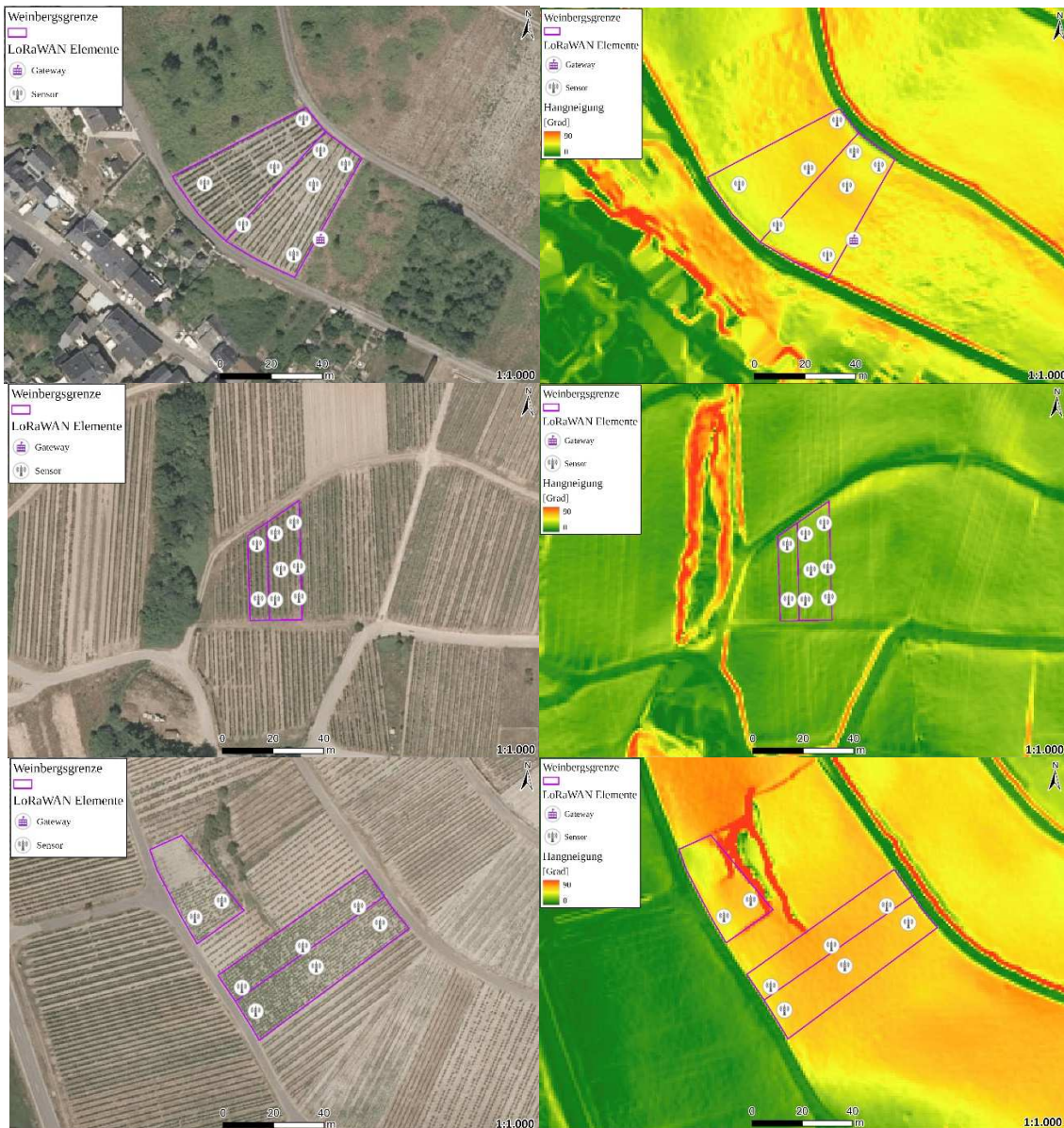
Abbildung 3: Sensorstandorte an der Mosel. Links Satellitenbilder, rechts digitale Geländemodelle mit einer Farbskala, die die Hangneigung darstellt (Dunkelgrün = 0°, gelb = 45°, dunkelrot = 90°). Die einzelnen Anlagen, von oben nach unten: Fell (Weingut Katja und Daniel Regnery), Mehring (Weingut Christian Porten) und Neumagen (Weingut Arnold Scholtes). Die lila Linien sind die Flurstücke aus dem Kataster.
